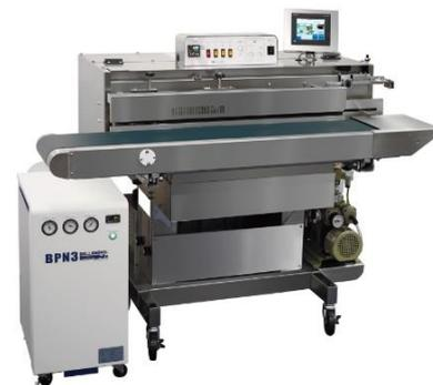
**特徴：** ガス置換とは袋の中の空気を抜き、用途に応じて炭酸ガスや窒素ガスを袋の中へ注入することができる機械です。ガス置換だけでなく、ガスの充填、強力脱気、シールのみも行うことができ、商品ごとに行いたい工程を選ぶことができます。また、それらの設定は50品目までバンク登録が可能のため、作業様が変わっても同じ条件でシールをすることができます。作業方法も簡単です。入口側にあるノズルに袋を差し込むとセンサが感知し、電動アクチュエータによってノズルと袋が流れていきます。その後ご希望のガス置換や充填、シールを行い、完成です。
