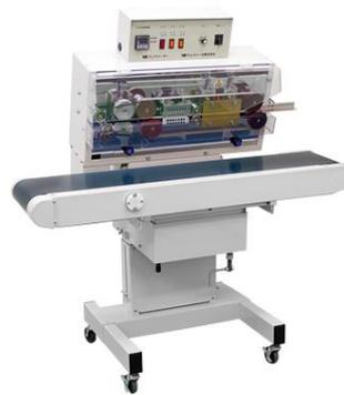
**特徴：** 袋を立てた状態で袋の封する部分をベルトではさみ、移動させながら封緘していきます。ヨコ型のシール機ではできない粉体や液体の商品をシールすることが得意な機種です。作業者様にはたっただま作業していただきますので、お手元を見ながらシールすることができます。袋の形状はスタンドパックがおすすめですが、一部の平袋でも対応できます。シールヘッドの傾きとコンベヤの上下を調整することで様々な大きさの袋がシール可能です。商品が入った状態の袋を見て可能かどうかを確認させていただきます。傾きの調整などは力を入れることなく簡単に行うことができます。多数の商品を扱ってられるお客様でも商品が変わるごとの調整に負担はかかりません。シールヘッドはヨコ型シール機と同じ水平まで傾きを戻すことができますので使い方は多様です。
